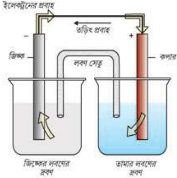
চিত্র 3.1 : জিঙ্ক ও তামার লবণের দ্রবণে আংশিক নিমজ্জিত জিঙ্ক ও কপার তড়িৎদ্বার সহ একটি ড্যানিয়েল কোশ।
