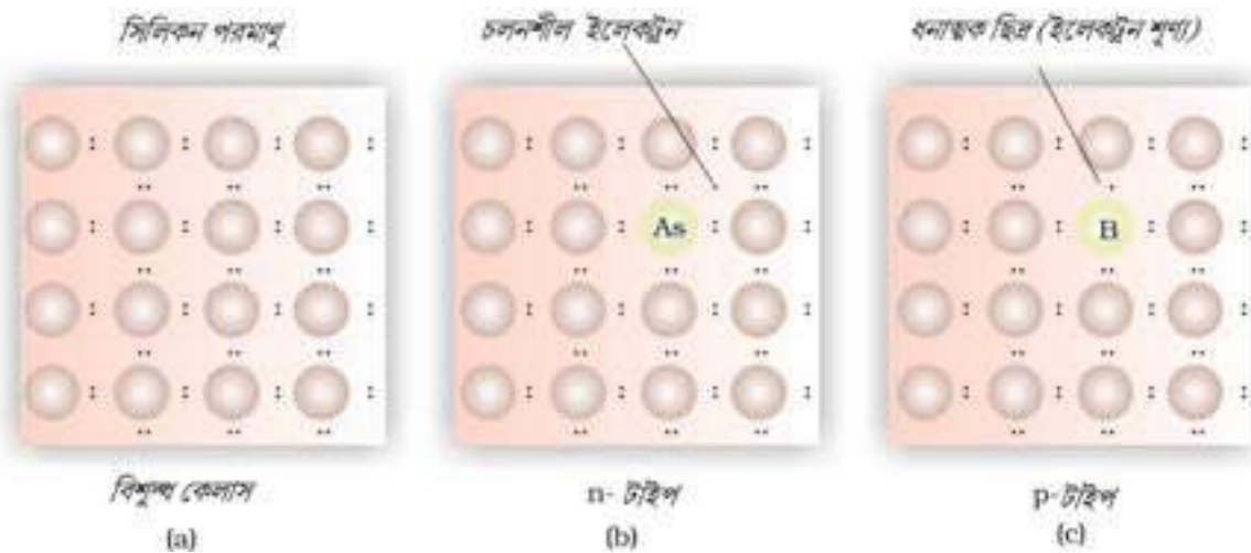
চিত্র 1.34: গ্রুপ 13 এবং 15 মৌলগুলো ডোপিং করে n -টাইপ ও p -টাইপ অর্ধপরিবাহী সৃষ্টি।
